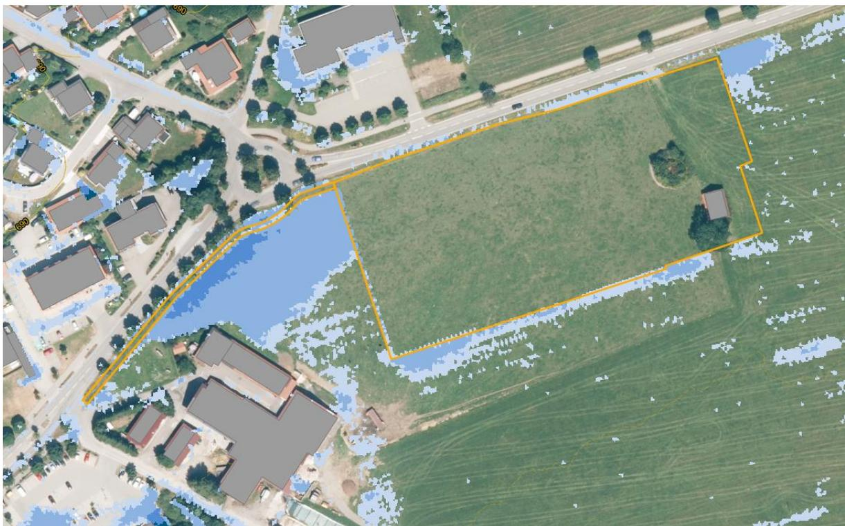
Abbildung 3: Maximale Überflutungstiefen bei einem 100-jährlichen Regenernis – Modelltechnische Planung
