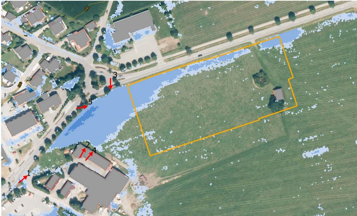
Abbildung 1: Maximale Überflutungstiefen bei einem 100-jährlichen Regenereignis – Bestandsgelände
